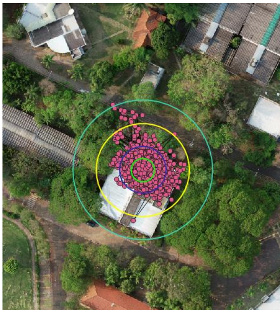
Figura 75: Distâncias geodésicas em metros no RTKPOST.
